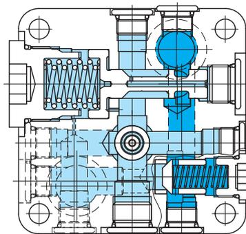
●由于附带有压力·温度补偿结构，所以即使负载压力及液压油的温度发生变化，流量也会保持稳定。另外液压油可以反方向自由流动。
